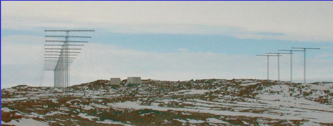
16本のログペリアンテナによる 1次元のメインアレイ
