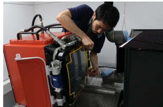
図 1 焦点面カメラに保護窓を取り付ける様子
