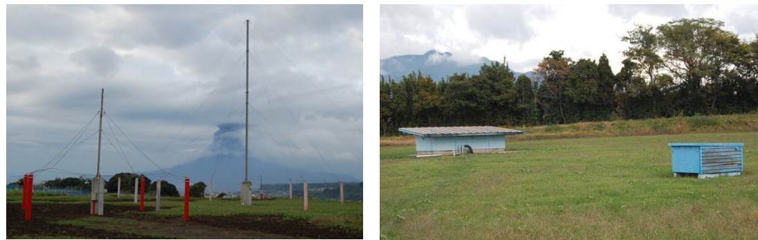
上の台地観測点（垂水）のVLF/ELFアンテナ（左）と磁力計小屋（右）
